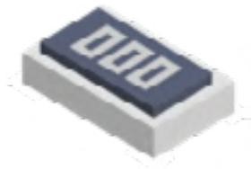
La composition des résistances est extrêmement variable selon leur spécifications, âge, type et fabricant, pour des aspects extérieurs identiques au sein d'un même type. Le cuivre y est quasiment toujours présent, mais on peut y trouver aussi du nickel, chrome, tantale, molybdène, ruthénium, silicium, aluminium, manganèse, gallium ou de l'argent.
